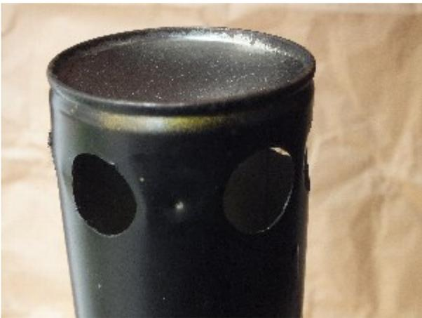
8、煙突のスプレー容器は、最初にガスを抜いて下さい。
